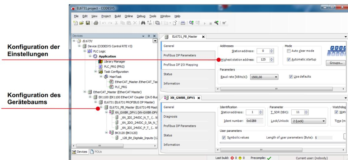
Bild 1: Konfigurationsdialog des EL6731-Konfigurators
